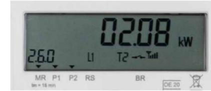
Zudem wird der exakte Zeitpunkt, jede Viertelstunde (hh:00, hh:15, hh:30, hh:45), der Leistungsspitze angezeigt.
