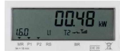
Zudem wird der exakte Zeitpunkt (Viertelstundenwert) der Leistungsspitze angezeigt (Uhrzeit + Datum).
